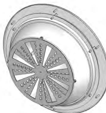
UGR avec registre à volet coulissant en acier galvanisé Sendzimir réglable par la bouche de la buse
